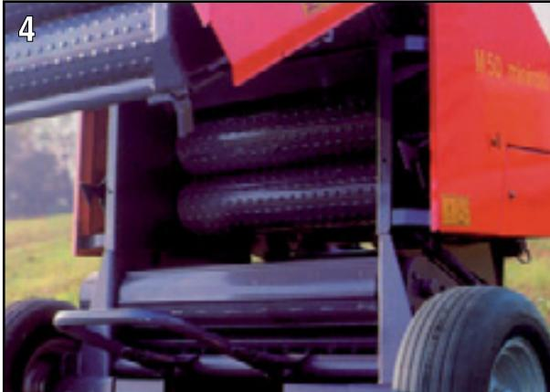
**1** **4.** La camera di compressione a rulli è fissa. L'allontanatore (di serie) consente di scaricare la ballo oltre il raggio di chiusura del portellone.
