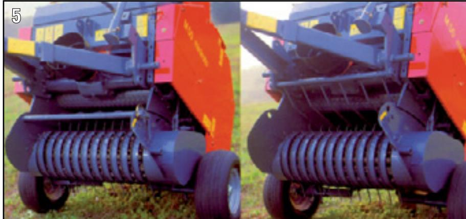
**2** **4.** La cámara de compresión a rodillos es fija. El distanciador de pacas (de serie) permite descargar la paca más allá del radio de cierre de la puerta.
