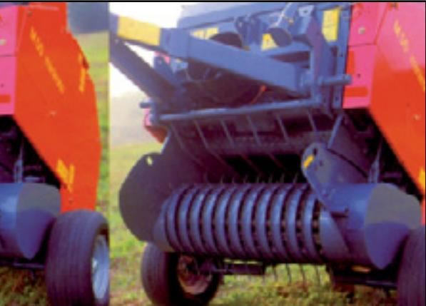
**3** **4.** La chambre de compression à rouleaux est fixe. L'éloigneur (de série) permet de décharger la balle au-delà du rayon de fermeture de la porte arrière.
